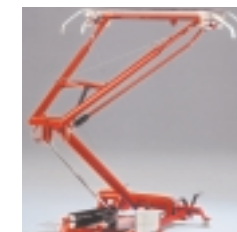
Stromabnehmer mit höchster Seitensteifigkeit, einzeln gefederten Schleifstücken und hydraulischer Scherendämpfung
