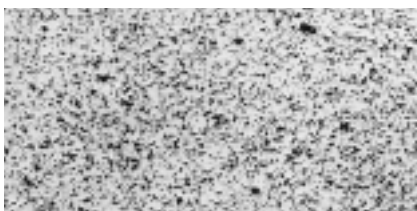
Querschliff Ag/CdO SP Cross section Ag/CdO SP Coupe transversale Ag/CdO SP
