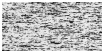
Längsschliff Ag/C Longitudinal section Ag/C Coupe longitudinale Ag/C
