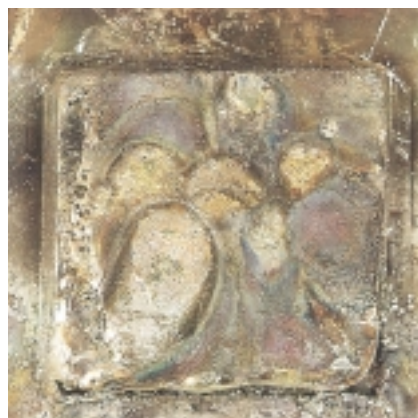
Oberfläche nach AC 4 Ag/CdO SP Surface after AC 4 Ag/CdO SP Surface après AC 4 Ag/CdO SP
