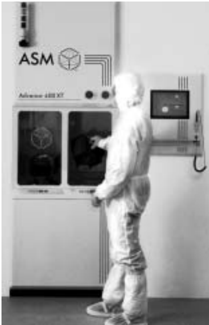
Vertikal-Ofen, bestehend aus zwei senkrechten Reaktoren und einer Waferbeladestation
