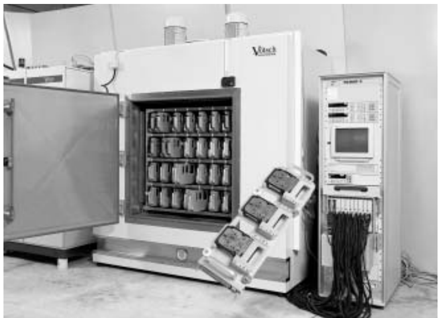
Prüfanlage zum Test von ABS Autoelektronik
